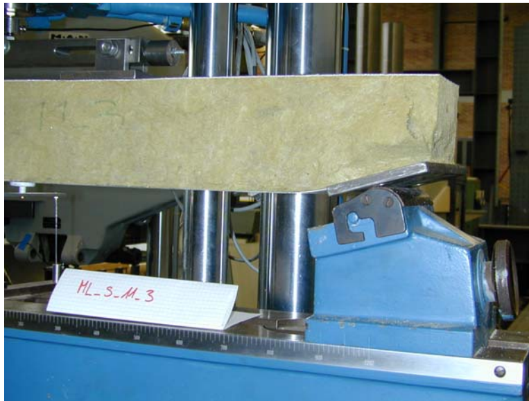
Abb. 10: Versagen des Mineralwollkerns unter einer Druckbeanspruchung am Auflager
