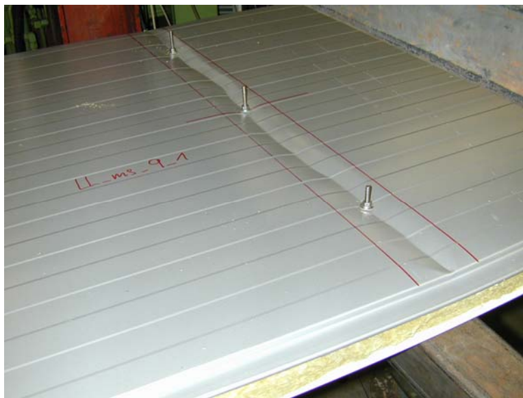
Abb. 9: Versagenszustand Knitern unter der Interaktion Biegung und Querkraft, Lasteinleitung durch die Schraubenköpfe zur Simulation des Lastfalls Windsog
