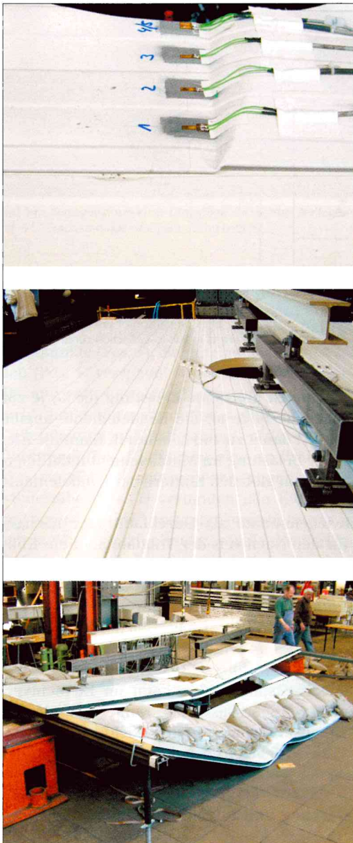
Bild 15. Knittern im Mittelelement, Fugenversagen, Knittern der Randlelemente
